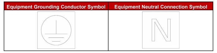
FIGURE 11. SYMBOLS ON CIRCUIT BREAKER BOX
