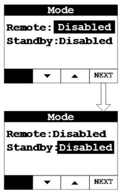
FIGURE 32. MODE SETUP SCREEN (LOCAL DISPLAY)
