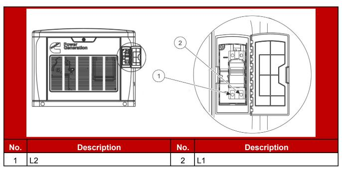
FIGURE 13. CIRCUIT BREAKER AC LOAD CONNECTIONS LOCATION
