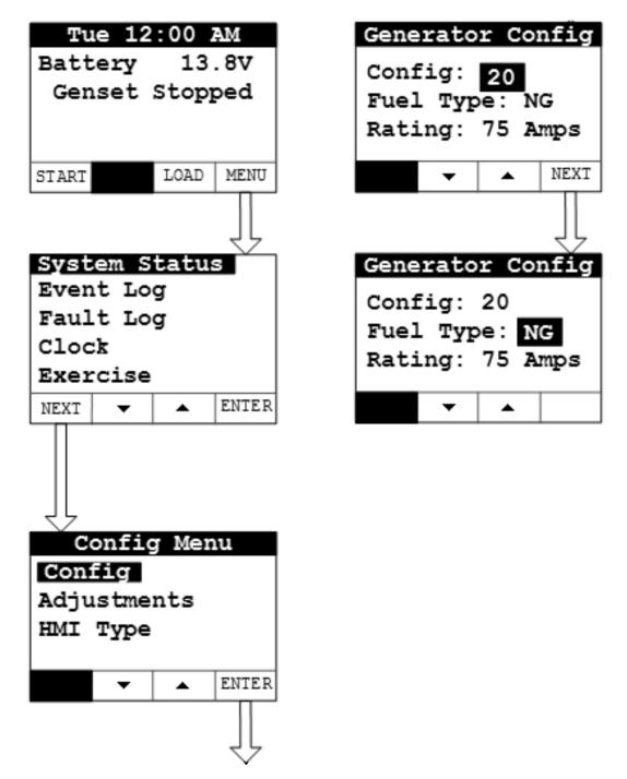
FIGURE 8. GENERATOR CONFIG SCREEN
