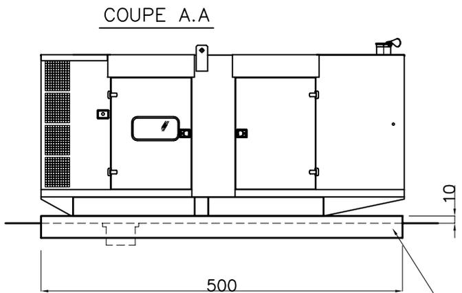
Epaisseur de dalle à déterminer en fonction de la nature du sol
